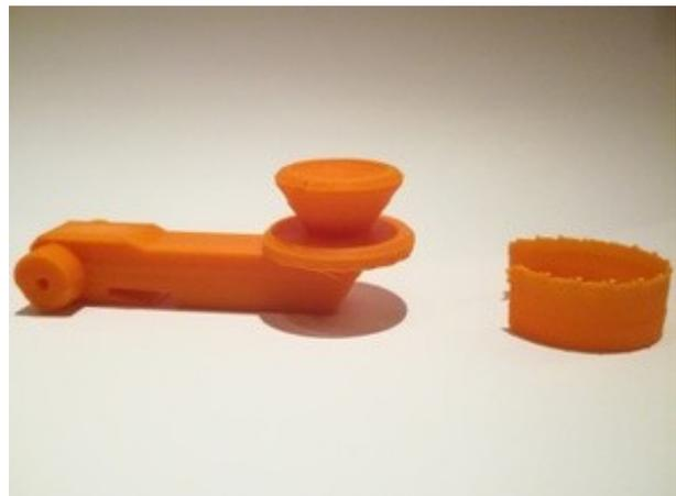
Arrache le support sous le bouton. Il ne sert qu'à l'impression : les premières couches du bouton du levier ne peuvent pas être imprimées dans le vide, ce support soutient les parties en surplomb.
