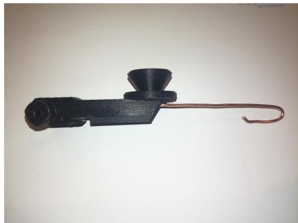
Insère le fil de cuivre de 10cm dans le trou à l'avant du levier.
