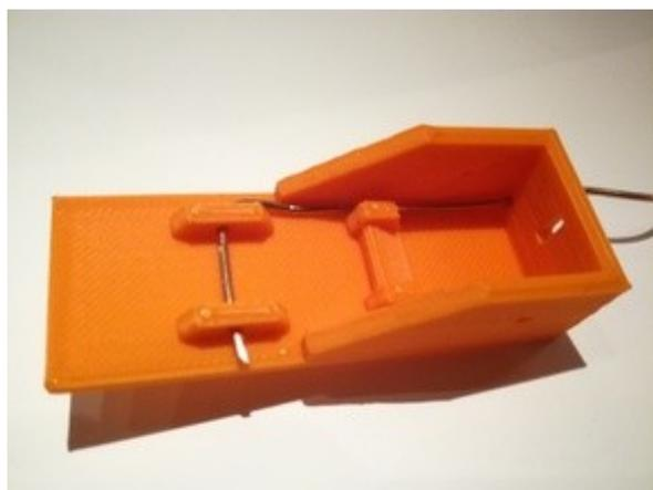
Aplatis la boucle sur le côté de la base. Tu peux t'aider d'une pince pour appuyer sur le fil, pour qu'il soit bien plat.
